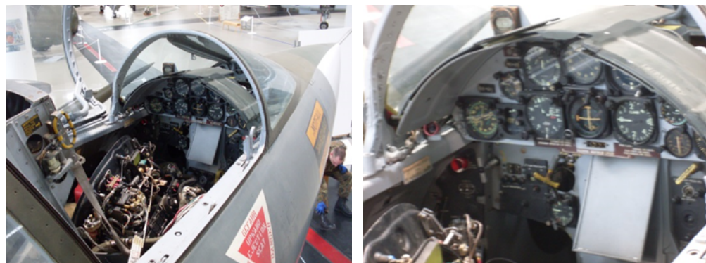
Abb. 4: Ansichten des Cockpits des F-104 G (Quelle Schirmer)
