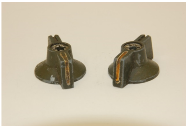
Abb. 1: Drehknöpfe und Sicherungsschalter mit Ra-226-haltigen
